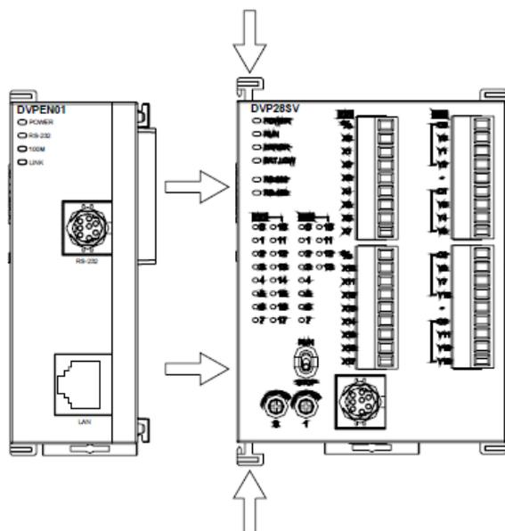
Для подсоединения следующего модуля к DVPEN01-SL необходимо снять заглушку на левой стороне модуля DVPEN01-SL, развести защелки, вставить следующий модуль, а затем снова закрыть защелки (см. рисунок ниже).
