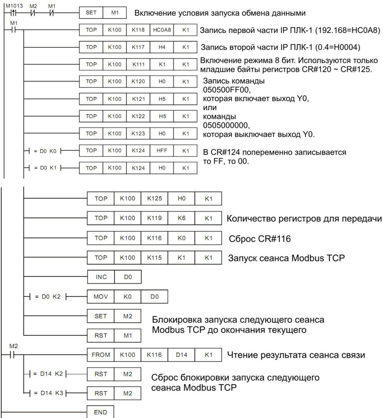
Выход Y0 будет секунду включен и секунду выключен.
