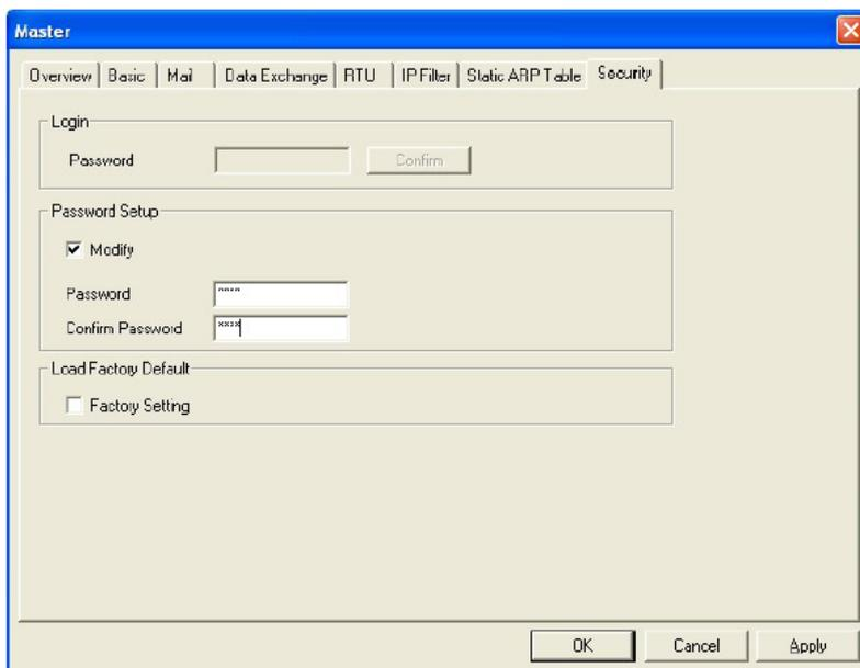
После установки пароля доступ к модулю будет закрыт. В случае утери пароля модуль можно будет сбросить на заводские установки только через порт RS232. Процедура описана в следующем разделе.
